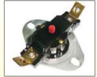
Los termostatos bimetálicos de temperatura fija son dispositivos cuyas temperaturas están fijadas de fábrica y que no tienen acceso al punto de ajuste por parte del usuario. Se utilizan, dependiendo del modelo, como dispositivos de control o de seguridad. Los contactos pueden ser de acción lenta o rápida, control o reinicio, normalmente abiertos, normalmente cerrados o de doble tiro (SPDT). Casi todas las opciones de contactos descritas anteriormente son posibles.
