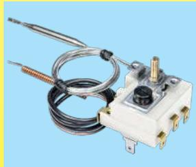
Termostato combinado de bulbo y capilar de tres polos con punto de ajuste variable y corte de seguridad fijo, utilizando expansión líquida.
